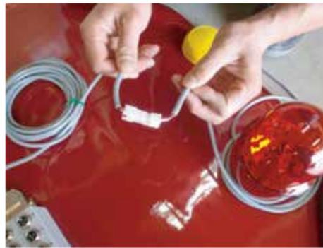
③ランプ&早押しボタンのケーブルのコネクタをケーブルのコネクタに接続します。
